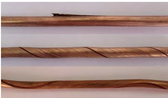
شکل (۴): نمونه‌ای از مفتول خراب
