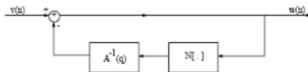
شکل ۲-۴- بلوک دیاگرام pre linearizer سیستم توصیف شونده با سری Volterra
