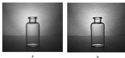
شکل ۳ نمایش تیز کردن تصویر، (a) تصویر اولیه؛ (b) تصویر تیز شده
